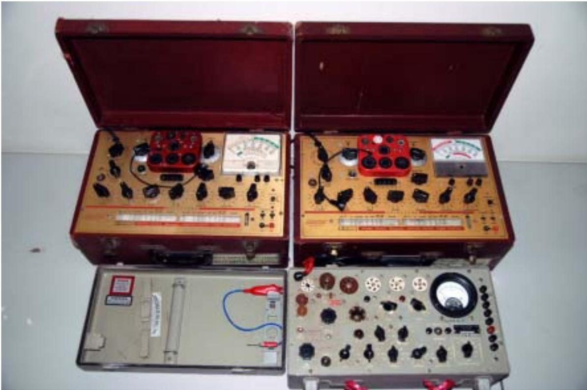
接下來則是用來測試功率管與配對用的器材，他們是由多台儀表組合起來的一個測試平台，這跟我想像中測管的方式完全不同，我一直以為一台測管機就可以做完所有的事，沒想到陣仗如此大。
