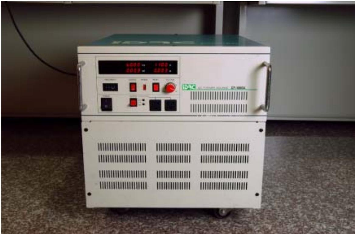
據工作人員說明，很多廠商都忽略這種設備，直接把測試儀表插在牆上電源孔就測試，基本準確度就會受影響。這台機器非常重，我估計可能超過 60 公斤。
