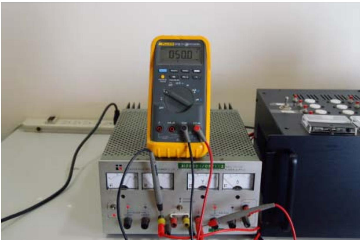
以我這次要買的 KT88 來說，測試的方式是高壓 420V，偏壓 50V。工作人員表示，客人如果有特別要求的設定方式，他們也可以配合測試。
