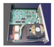
內置 2 級升頻器,首先將 CD 的採樣頻率從 16 比特 44。1KHZ 升到 24 比特 96KHZ, 然後再把 96KHZ 的採樣頻率升至 192KHZ。
